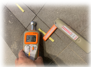
追蹤器可配合波頭濕度計找瓦底暗喉濕位
