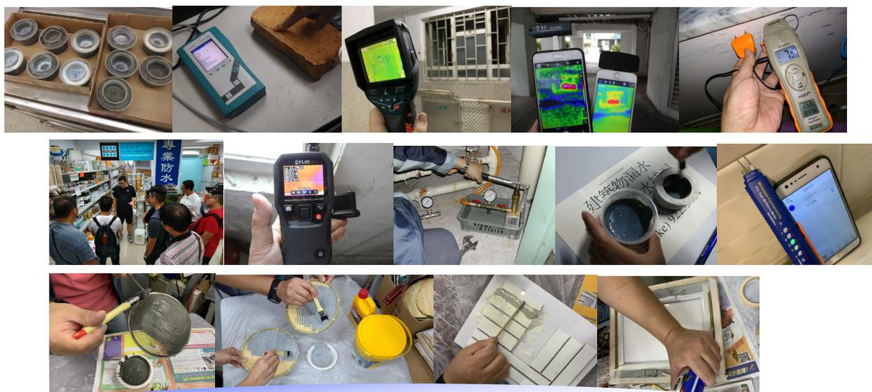
出資廿多萬元購買多款紅外線熱熱像儀 Infrared Imager，微波濕度掃描 Microwave Moisture Scanner 及十多款濕度計 Moisture Meter 供學員示範/實習
